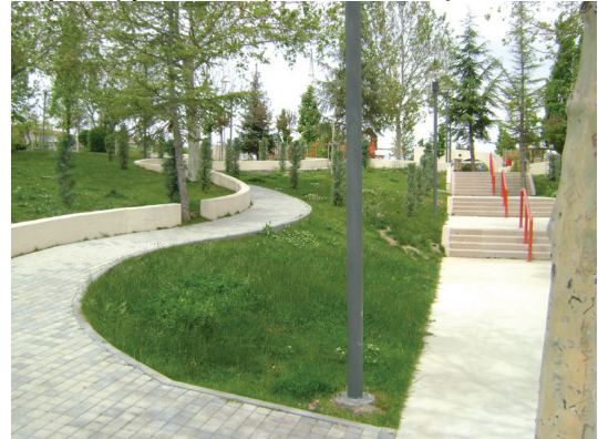
Şekil 9. Park içerisindeki kot farklılıkları basamak ve rampa çözümleri
